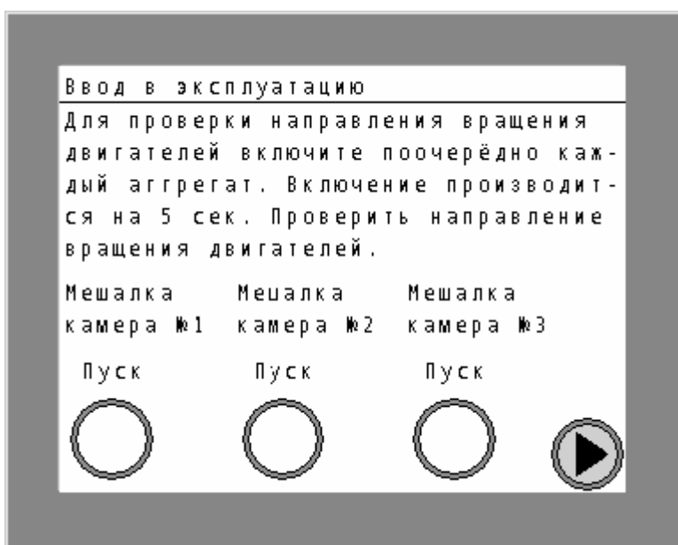
Рис. 20 Пуско-наладка установки: проверка направления вращения мешалок
