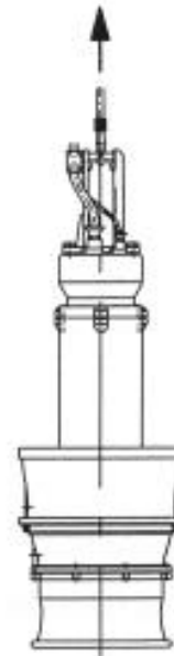
Рис. 1 Транспортировка насосного агрегата
