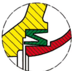
Кольцо износа в ходе эксплуатации
