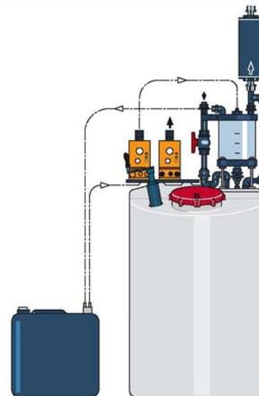
Системы дозирования DULCODOS® Hydrazin – это собранные, готовые к эксплуатации, легко подключаемые системы для приготовления и автоматического дозирования раствора гидразина. Гидразин используется в водяных и паровых системах в качестве антикоррозионного ингибитора. Для предотвращения вреда здоровью при работе с гидразином, особое внимание уделено газонепроницаемости дозирующей установки, начиная с изъятия из стандартной упаковки и до начала дозирования в питательную воду котла.
