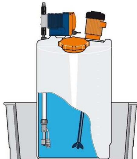
Дозирующие станции DULCODOS® eco с емкостью подходят для приготовления и дозирования жидких химикатов. Благодаря системе подбора (по идентификационному коду) они могут быть легко, быстро и удобно приспособлены под выполнение конкретных задач дозирования.
