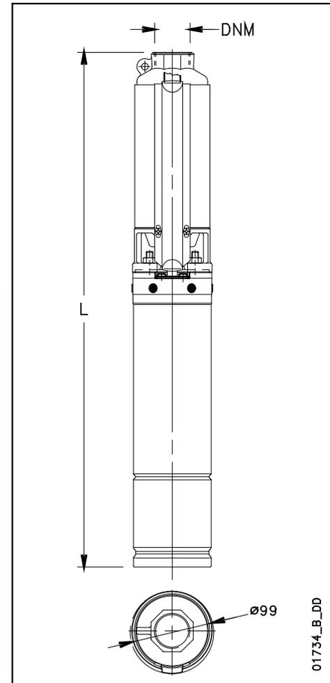
\* Насосы длиной более 1500 мм поставляются разобранными на две части. Электродвигатель и насос упакованы раздельно.
