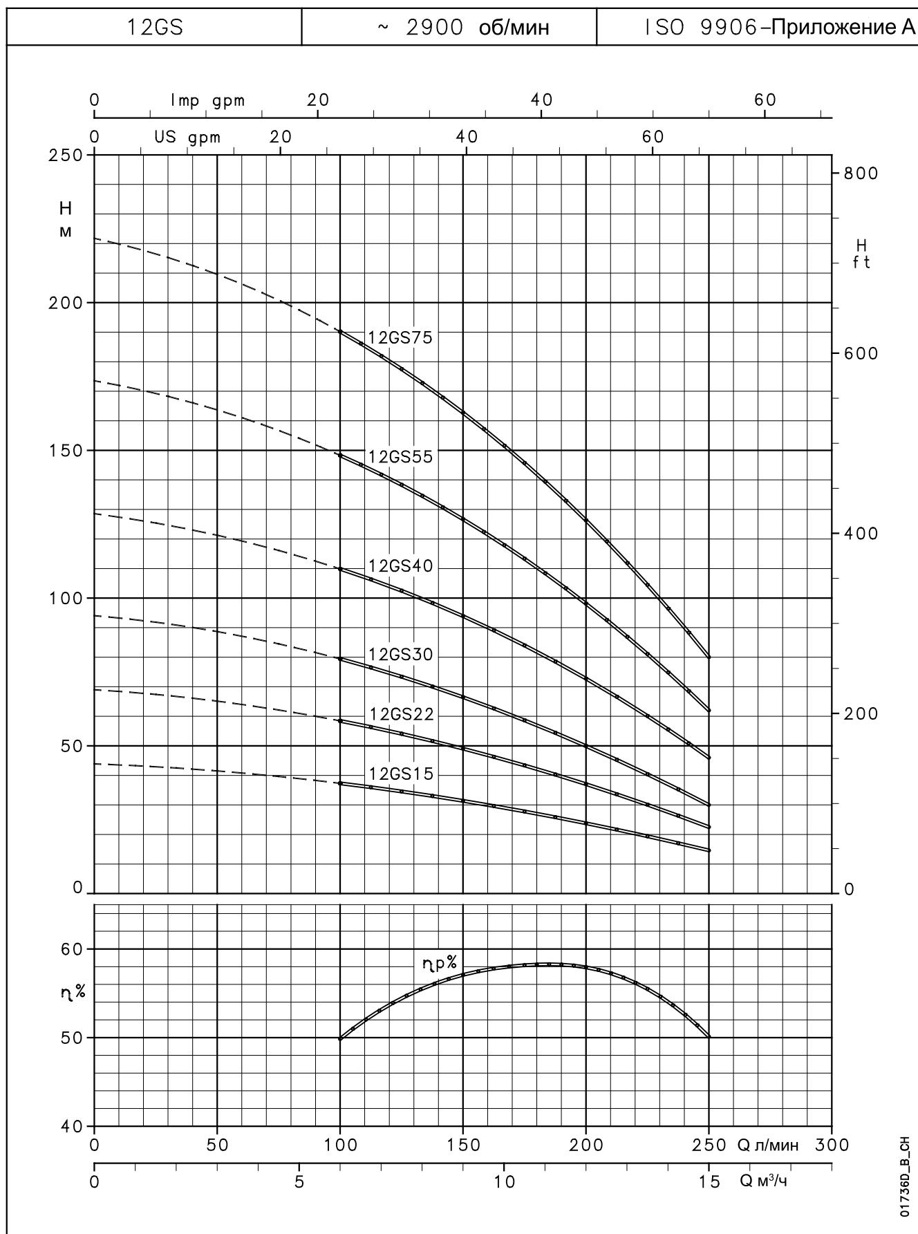
Характеристики приведены для жидкостей с плотностью  $\rho = 1.0 \text{ кг}/\text{дм}^3$  и кинематической вязкостью  $\nu = 1 \text{ мм}^2/\text{сек}$ .
