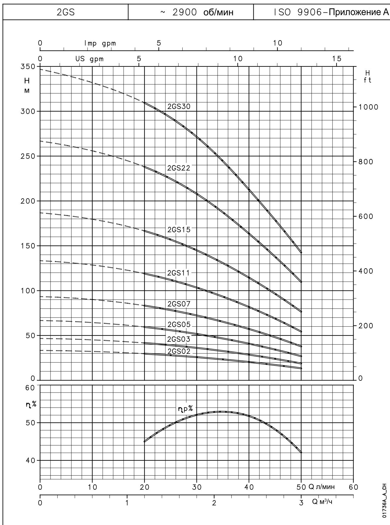
Характеристики приведены для жидкостей с плотностью  $\rho = 1.0$  кг/дм<sup>3</sup> и кинематической вязкостью  $v = 1$  мм<sup>2</sup>/сек.
