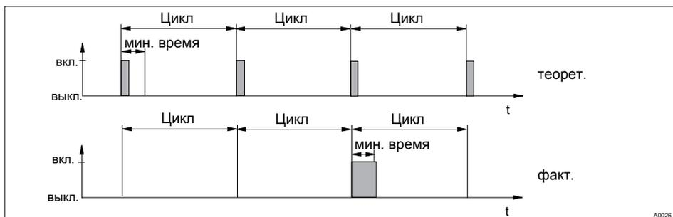
Рис. 34: Теоретическое значение времени переключения < мин. времени
