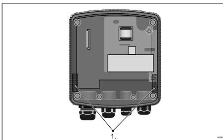
Рис. 50: Установка профильного уплотнения на нижнюю часть корпуса регулятора
