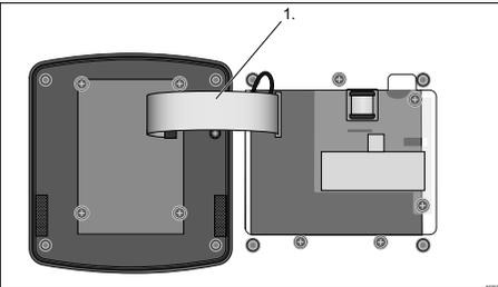
Рис. 46: Отсоединение плоского кабеля от корпуса
