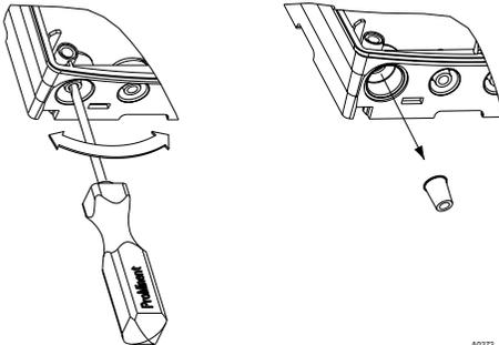
Рис. 43: Выламывание резьбовых отверстий
