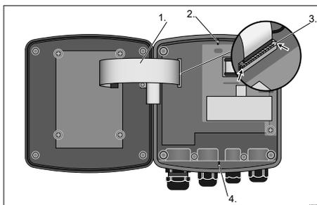
Рис. 41: Снятие плоского кабеля
