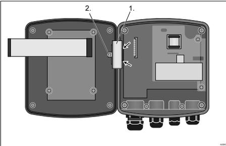
Рис. 37: Демонтаж шарнира
