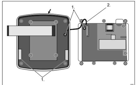
Рис. 48: Демонтаж ленты для снятия нагрузки
