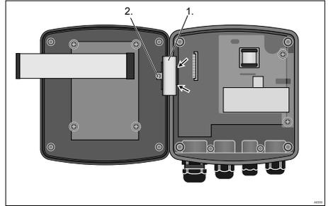
Рис. 47: Демонтаж шарнира
