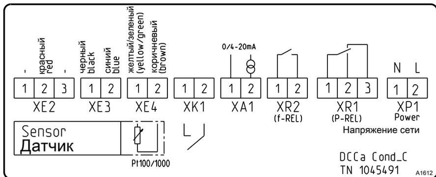
Рис. 12: Наклейка со схемой клеммных соединений регулятора Compact, цвет кабеля указан для проводки к измерительному прибору ☞ «При использовании датчика без несъемного кабеля или для удлинения несъемного кабеля необходимо использовать предварительно смонтированные кабели датчиков:» на странице 42
