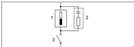
Рис. 16: RC-блок схемной защиты для контактов реле
