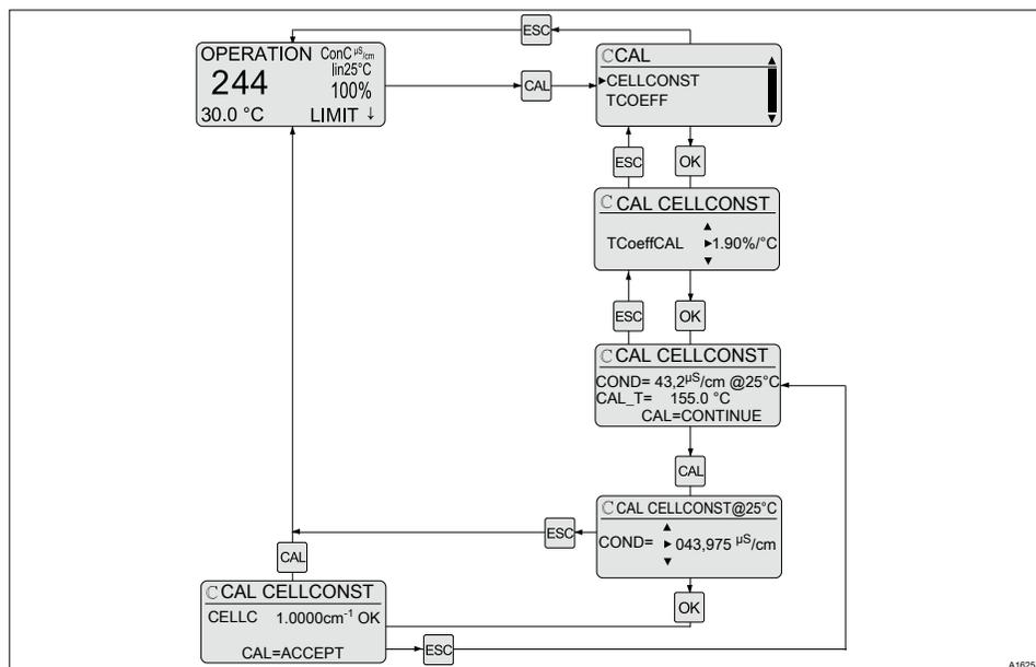
Рис. 23: Калибровка постоянной ячейки
