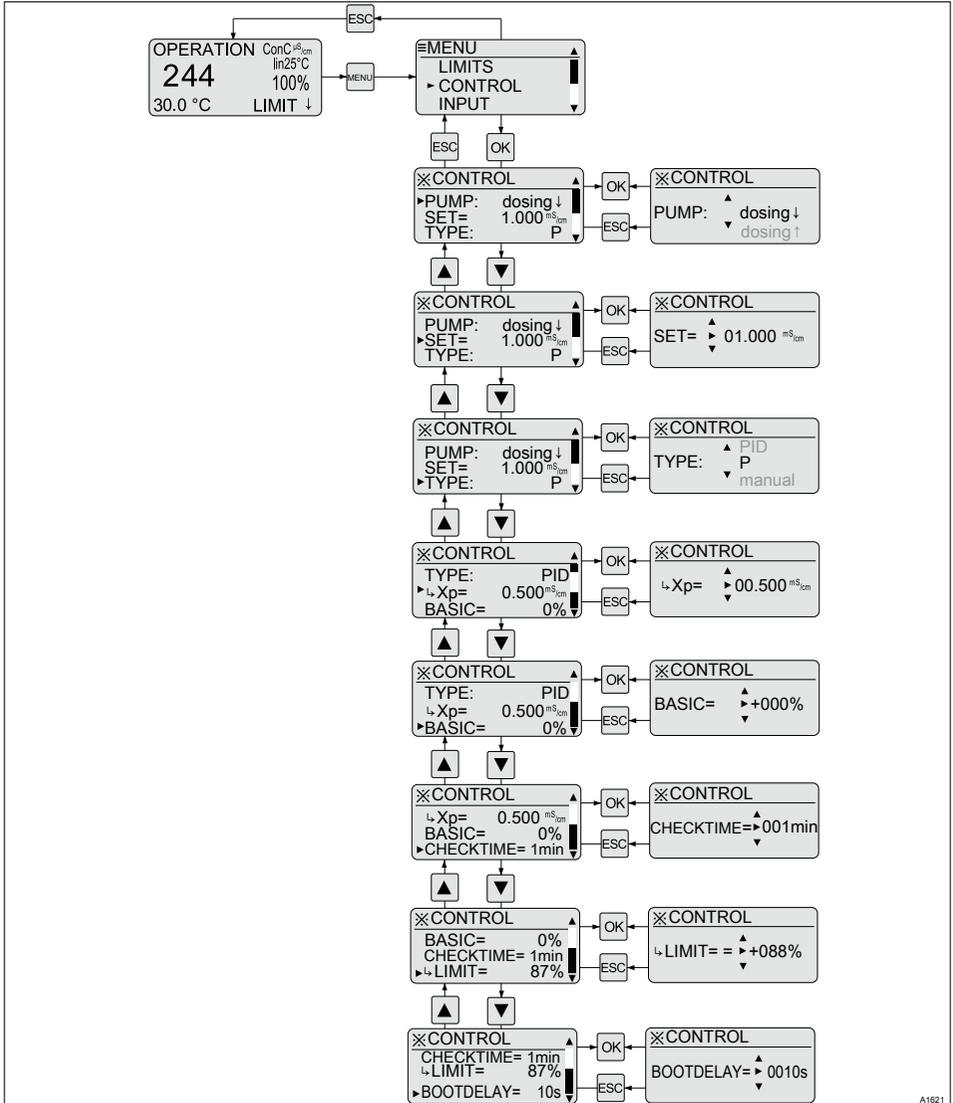
Рис. 26: Настройка регулировки [CONTROL]
