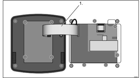
Рис. 39: Вставьте плоский кабель в цоколь и зафиксируйте его
