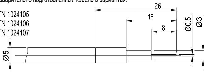
Рис. 18: Сборка коаксиального кабеля
