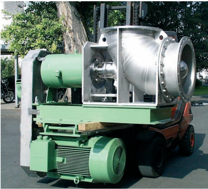
R PROP 600 mit Riementrieb und Motorwippe für den Einsatz in einer Kristallisationsanlage. R PROP 600 с ремённым приводом и натяжным устройством для использования в кристаллизаторах.
