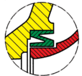
Кольцо износа в нерабочем состоянии
