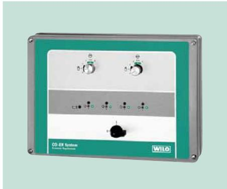
Прибор управления одним или несколькими однофазными или трехфазными насосами с мощностью до 3 кВт (max 10/8,5 A), их защиты и сигнализации, предназначенный для систем водоснабжения и повышения давления
