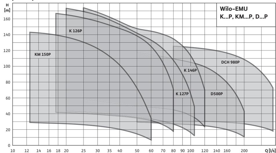
3~400 В, 50 Гц,  $\rho = 1 \text{ кг/дм}^3$ ,  $\nu = 1 \times 10^{-6} \text{ м}^2/\text{с}$ , ISO 9906 приложение А,  $\eta = \text{КПД насоса}$
