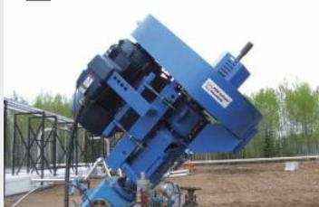
Наземное размещение насоса PCM Vulcain™ HT на скважине с циклической интенсификацией добычи закачкой пара в пласт [используется вместо штангового глубинного насоса]
