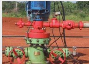
В состав встроенного противовыбросового устройства входят собственно устройство и тройник. Кроме того, оно поставляется вместе с патрубками низкого давления [LP] диаметром 2" и 3" для присоединения наземного датчика и реле давления. Устройство совместимо с полированными штоками и поставляется с плашками размером 1½" или 1¾", верхом 3⅛" и дном 4⅓", рассчитанными на напор 3000 фнт./кв. дюйм, кроме того, в комплект входят все необходимые штифты и гайки.
