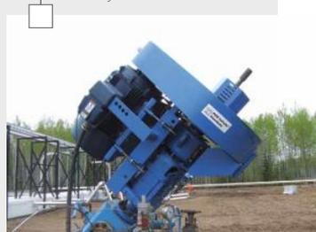
Наземное размещение насоса PCM Vulcain™ HT на скважине с циклической интенсификацией добычи закачкой пара в пласт (используется вместо штангового глубинного насоса)
