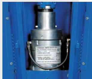
Для всех моделей вращателей предлагается уплотнение вращательного соединения Огух, нуждающееся в малом объёме технического обслуживания и надёжно предотвращающее протечки. Система раннего оповещения о нарушении герметичности уплотнения помогает минимизировать неблагоприятное воздействие на окружающую среду.
