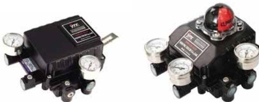
Позиционеры YP-1200, YP-1200L для пневматических приводов арматуры управляемых пневматическими контроллерами или системами управления с выходным сигналом от 3 до 5 psi или разделённым диапазоном.
