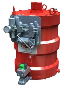
CQ - компактный четвертьоборотный привод с системой управления полностью концентрической конструкции на основании винтового механизма, преобразующего линейное перемещение поршня в четвертьоборотное вращение вала арматуры.
