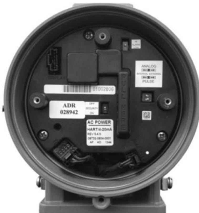
Рисунок 2.24 – Расположение переключателей на плате электроники преобразователя
