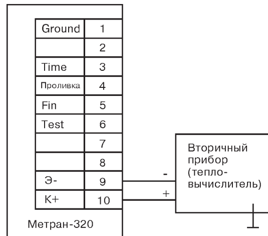
Рис. 1. Схема подключения расходомера Метран-320 к вторичному прибору.
