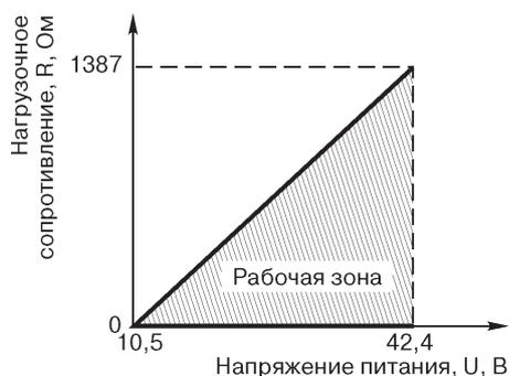
Рис. 1. Выходной сигнал 4-20 мА.
