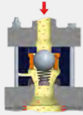
Подпружиненный шаровой клапан для обратного потока
