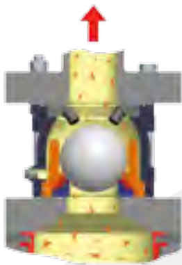
Шаровой клапан с металлическим и дополнительным мягким уплотнением
