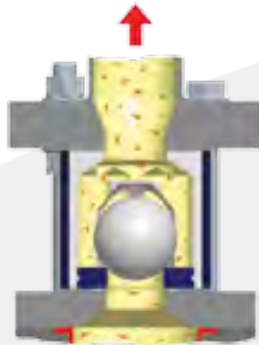
Шаровой клапан из полипропилена с металлическим упрочнением
