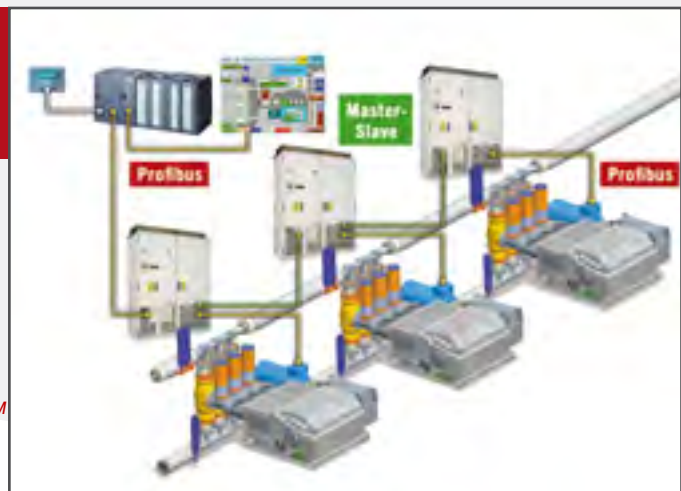
Три FELUWA MULTISAFE насоса соединенных в общую сеть. Система FELUWA позволяет контролировать фазы работы насосов, тем самым предотвращая появление резонанса.
