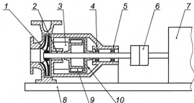
1 — гидравлическая часть; 2 — подшипник; 3 — оболочка; 4 — корпус подшипника;
