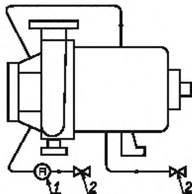
Охлаждение или обогрев через область привода и рубашку корпуса
