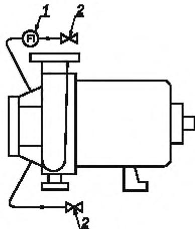
Охлаждение или обогрев через рубашку корпуса
