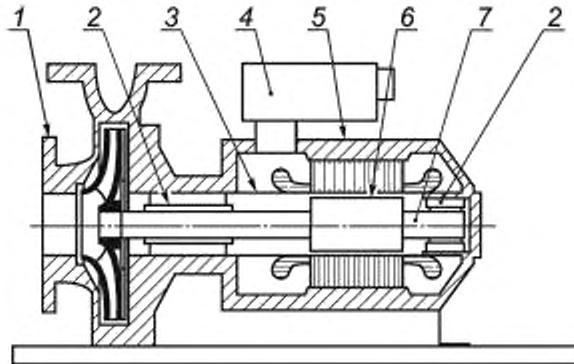
1 — гидравлическая часть; 2 — подшипник; 3 — гильза (вкладыш); 4 — кабельный ввод;
