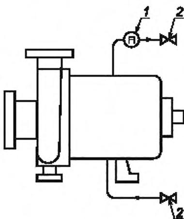
Охлаждение или обогрев через область привода
