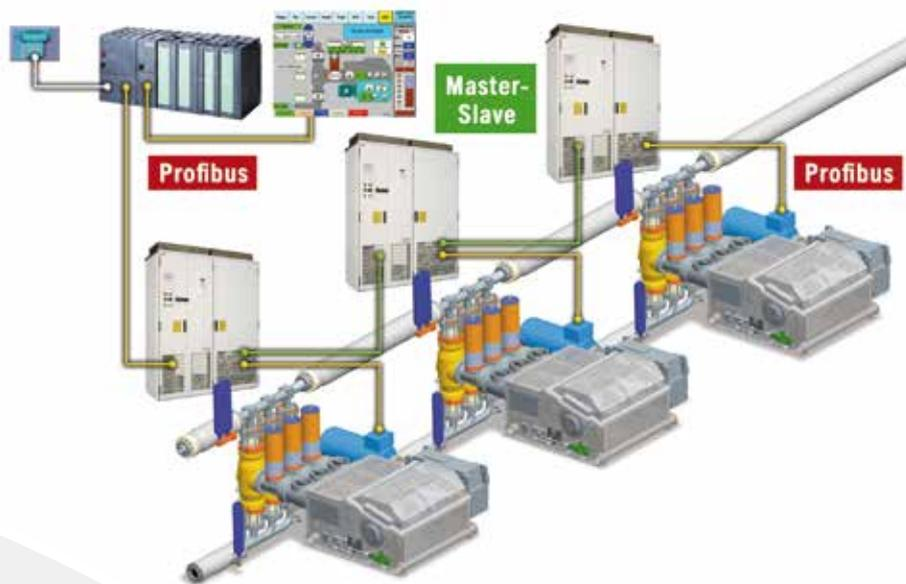
Необходим блок управления для синхронизации насосов, преобразователь частоты и датчик для определения угла поворота коленчатого вала для каждого насоса.
