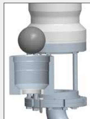
*Замена внутренних элементов клапанов с помощью системы быстрой замены FELUWA Quick Change.*
