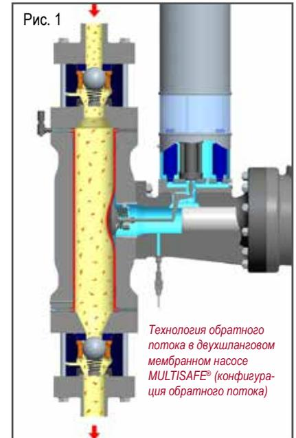
Технология обратного потока в двухшланговом мембранном насосе MULTISAFE® (конфигурация обратного потока)
