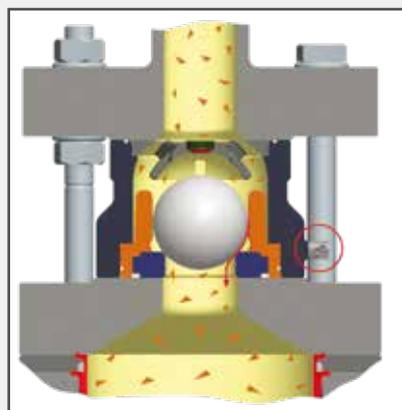
$P_{VD}$  Потери мощности из-за протечек клапана (износ) при нагнетательном ходе
