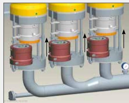
*Выведение двойных клапанов из рабочего положения путем вращения без демонтажа трубопровода.*
