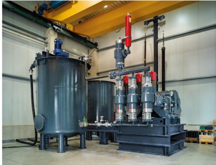
Рис. 1. Испытательный стенд FELUWA для тестирования перекачиваемых сред
