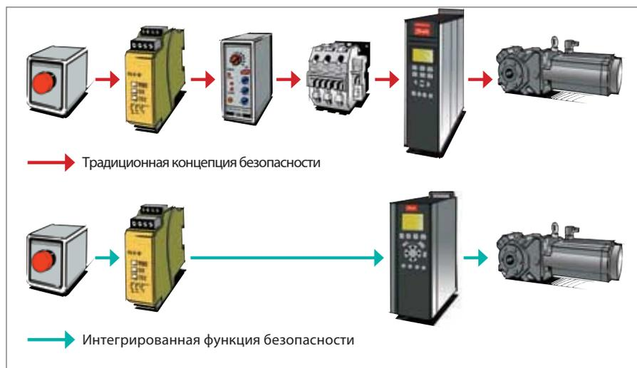
Можно исключить контакторы и таймер в системе безопасности, используя функции безопасности системы привода VLT® AutomationDrive.
