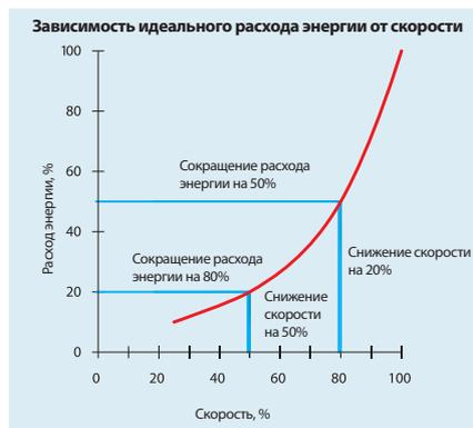
При использовании системы привода VLT® экономия энергии достигается даже при небольшом снижении скорости.
