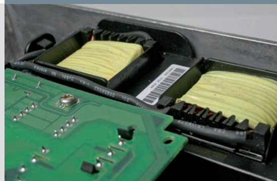
Катушки постоянного тока уменьшают гармонический шум и защищают привод.
