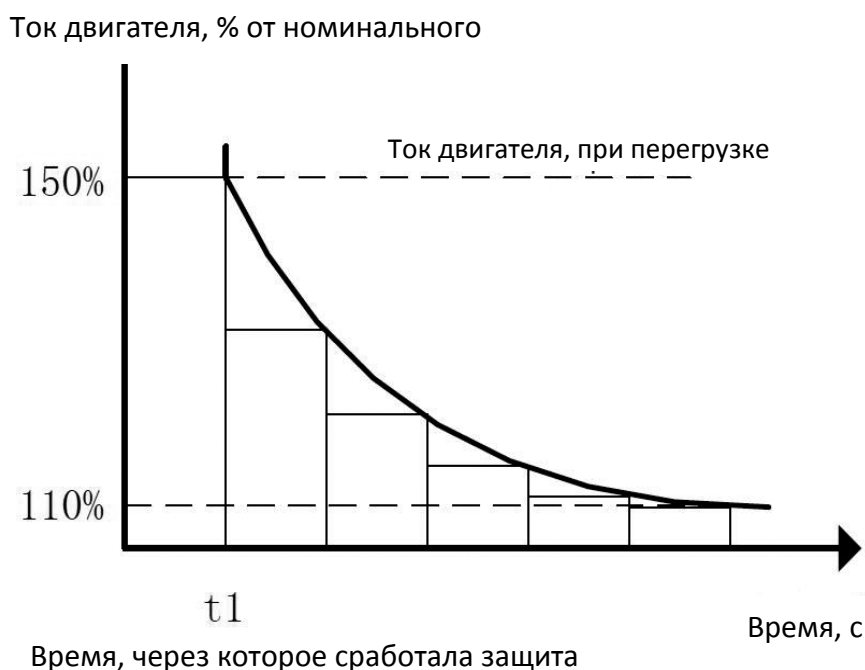
Рис. 8.5 - График функции защиты двигателя от длительной перегрузки по току
