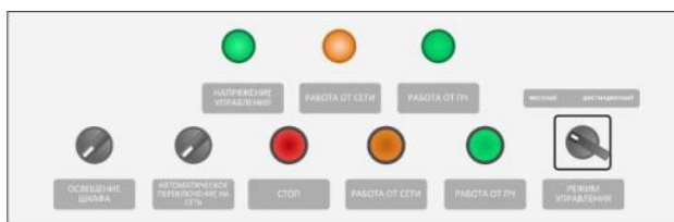
Рис. 6.8 - Панель управления системы автоматического байпаса
