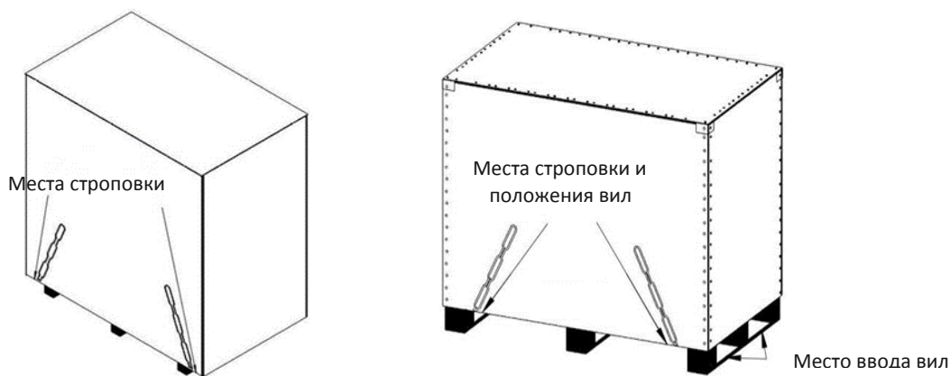
Рис. 2.5 - Строповка (паллеты с выступом - слева, паллеты без выступа - справа)
