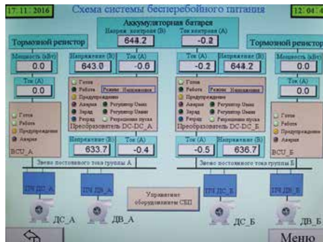
Главный экран панели управления системы бесперебойного питания
