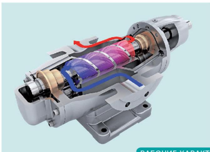
Винтовой насос L2 компании Leistriz - насос объемного типа, самовсасывающий, работающий при давлениях до 16 бар (232 фунт/кв.дюйм), идеально подходящий для перекачки слабоабразивных и коррозионных жидкостей с высокой или низкой вязкостью и с хорошими или плохими смазывающими свойствами.
