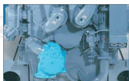
Насос смазки с приводом от двигателя L3NG
