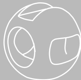
Благодаря специальной геометрической форме пропорционального шарового элемента кран С 200 может использоваться в качестве регулирующей арматуры с линейными характеристиками потока. Наличие отдельной шкалы в % позволяет быстро и точно настраивать требуемые параметры расхода.
